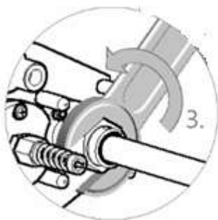
Obr. 8-Povolení táhla stěrače
